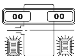
☆ スタートキーでタイヤを回転させ、停止後に表示が左図のようになるように、上記作業を切り返します。表示が左図のようになればバランス取りは終了です。
