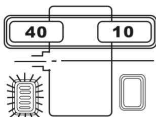
☆ 手でゆっくりとタイヤを回して、内側のインジケーターが全点灯した場所でタイヤを止め内側の12時の位置に40gのウェイトを貼ります。(打ち込みます。)
