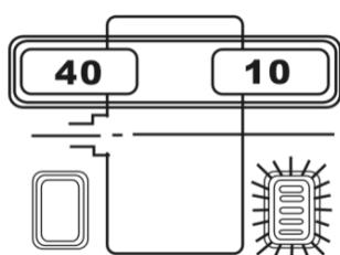
☆ 手でゆっくりとタイヤを回して、外側のインジケーターが全点灯した場所でタイヤを止め外側の12時の位置に10gのウェイトを貼ります。(打ち込みます。)
