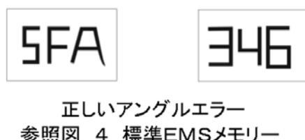
1. “R”キーを押し、0.5秒後にスタートキーも押す(Rキーは押したままです。)と、左図の通りの表示となります。点滅が点灯に変わるまで、両キー共に押し続けて下さい。点灯したら指を離して下さい。
