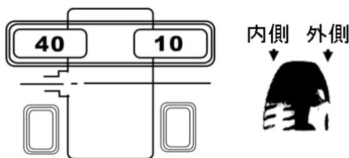
☆ スタートキーを押すとバランス取りを実行します。約8秒後に停止し、解析されたアンバランスを表示します。
