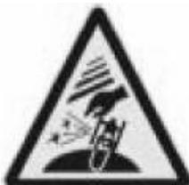
タイヤを押す際、開いたクランプシリンダーが作業員の手を傷つける場合があります。タイヤ側面に触れない。
