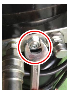
※降下速度を速く調整した後に重い車両を載せる場合は、危険ですので必ず再調整してからご使用ください。
