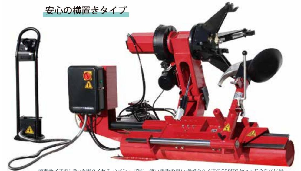
標準サイズのトラック用タイヤチェンジャーです。使い勝手の良い横置きタイプの588HCはヘッドを自在に動かす事によってタイヤを楽に装着することが出来ます。オプションを装着する事でアルミホイールも傷付けずに装着する事ができます。
