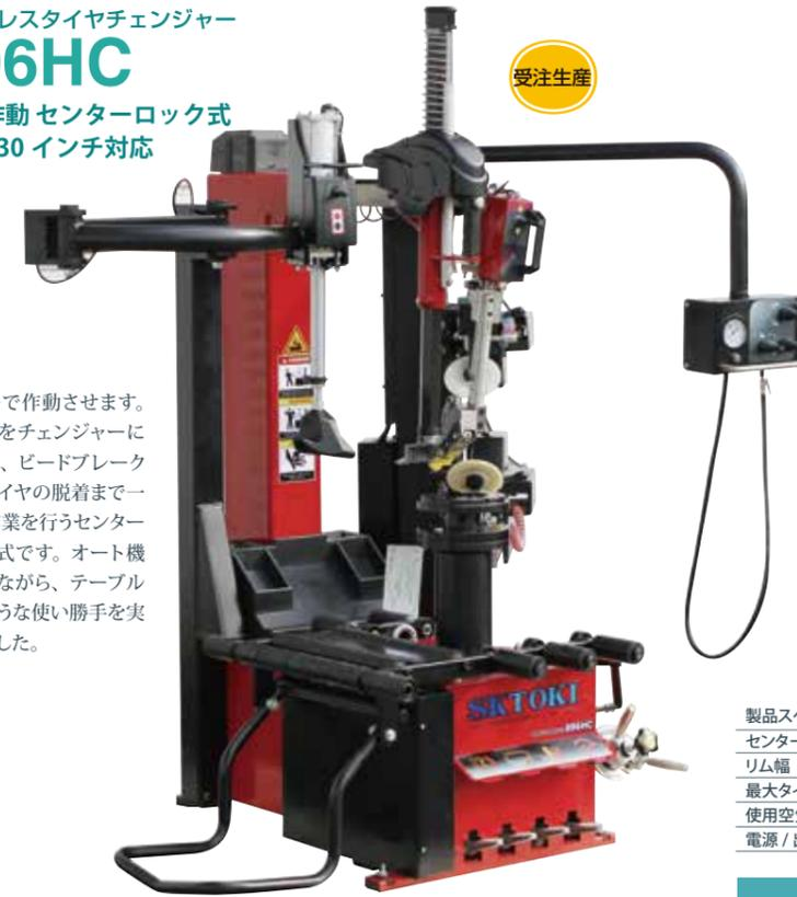
エアで作動させます。タイヤをチェンジャーに固定し、ビードブレイクからタイヤの脱着まで一連の作業を行うセンターロック式です。オート機でありながら、テーブル機のような使い勝手を実現しました。
