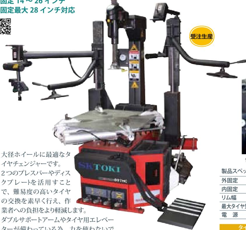
大径ホイールに最適なタイヤチェンジャーです。2つのプレスバーやディスクプレートを活用することで、難易度の高いタイヤの交換を素早く行え、作業への負担をより軽減します。ダブルサポートアームやタイヤ用エレベーターが備わっている為、力を使わないで丁寧な作業を行う事ができます。
